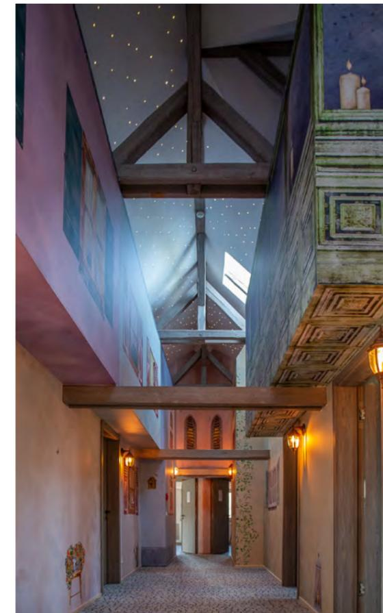
Der Sternenhimmel mit 900 LED-Lichtern im Flur dient zusätzlich als automatisch gesteuerte Notbeleuchtung.
